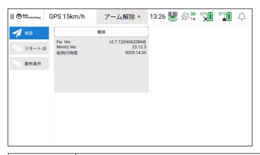
機体のファームウェアバージョン、及び総飛行時間を表示します。
