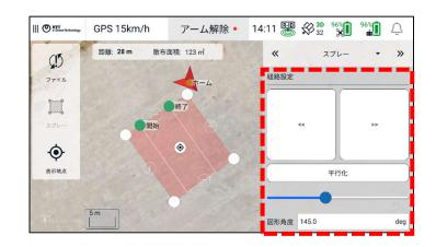
・機首反転:プラン開始時に機首方向が 180 度反転します。機首方向は開始点から次のウェイポイントの方向に従って決定されます。必要に応じてチェックしてください。(開始点が奥側の場合など)
