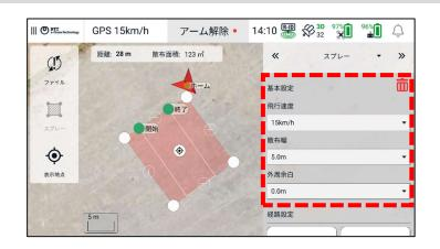
経路設定:適切なライン角度を設定【<<】【>>】ボタン:1度ずつライン角度を調整
